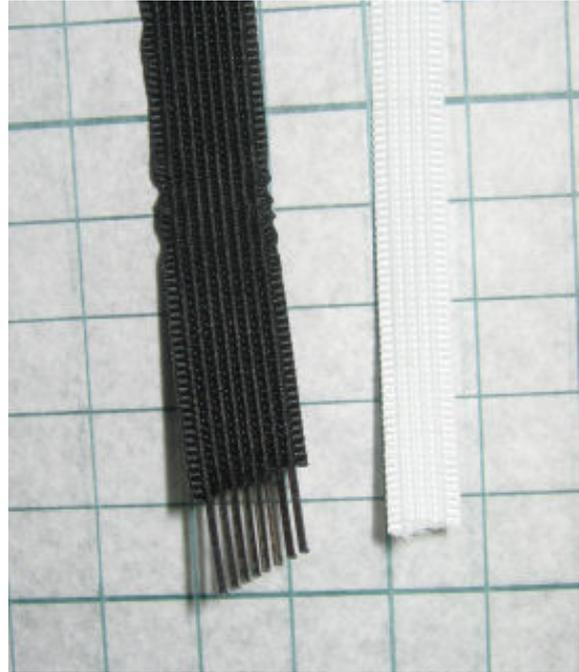
**Bild 1:** Rigeline Stäbchenband, links mit leicht herausgezogenen Plastikstäbchen
