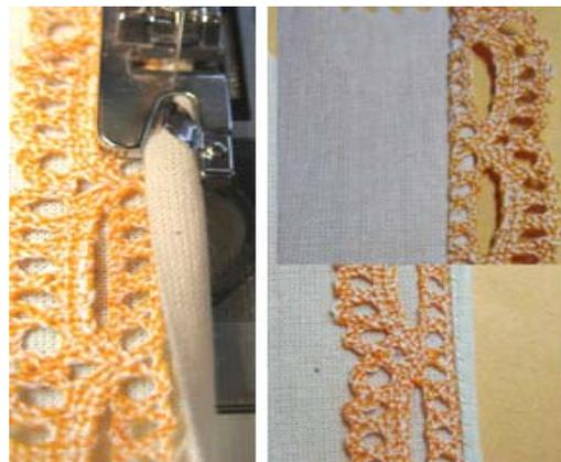
**Bild 11:** Borte mitgefasst, anschließend nach oben oder unten gelegt. In diesem Fall liegt die rechte Stoffseite oben.
