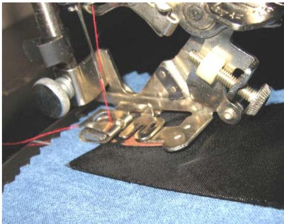
**Bild 8** Stoff liegt unter dem Fuß, Band zwischen den Zungen.
