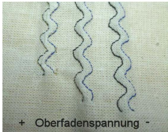
**Bild 3:** Wellenstich mit unterschiedlichen Fadenspannungen
