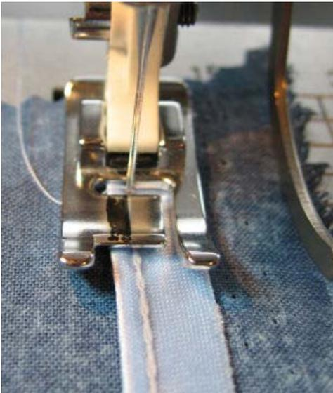
**Bild 3:** Position des Fußes und der Nadel zur Paspel
