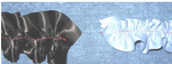
**Bild 9** Satin- und Baumwollband, mit Intervall 1 und 3 cm Stichlänge aufgesteppt
