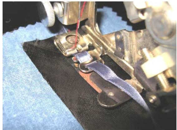
**Bild 10** Stoff liegt unter dem Fuß, Band zwischen den Zungen, Bändchen im Rechen vor der Nadel
