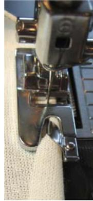
**Bild 3:** Korrekte Stoffzufuhr in die Schnecke
