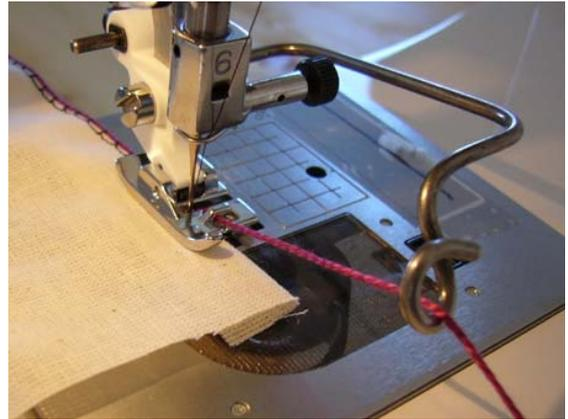
**Bild 7:** Husqvarna-Fadenführung und Einkordelfuß
