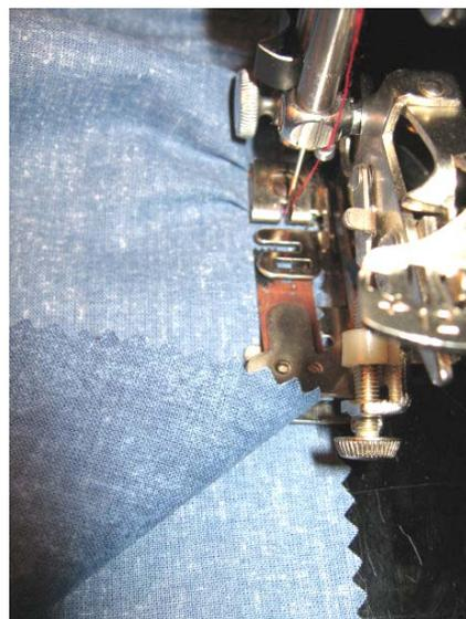
**Bild 6** Eine Stofflage in Falten legen und an eine glatte Stofflage annähen
