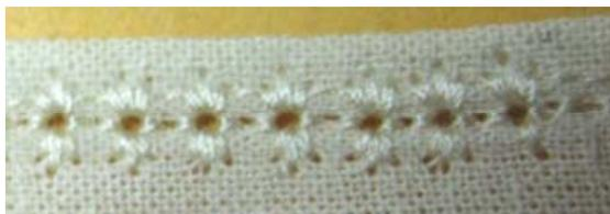
**Bild 8:** Naht nach dem Rollsäumen mit Hohlsaumnadel nachgesteppt, Garn passend zum Stoff gewählt
