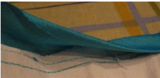
Bild 27: Schrägstreifen nach innen umlegen
